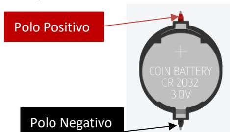
**TINKERCAD** A pilha tem **dois polos** (terminais). O **positivo** e o **negativo**. O **positivo** tem cor **vermelha** e o **negativo** cor **preta**.
