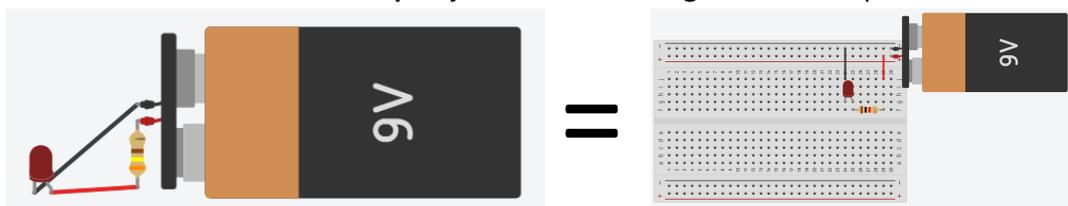
Se reparares é exatamente igual ao que tens montado na breadboard 😊.
