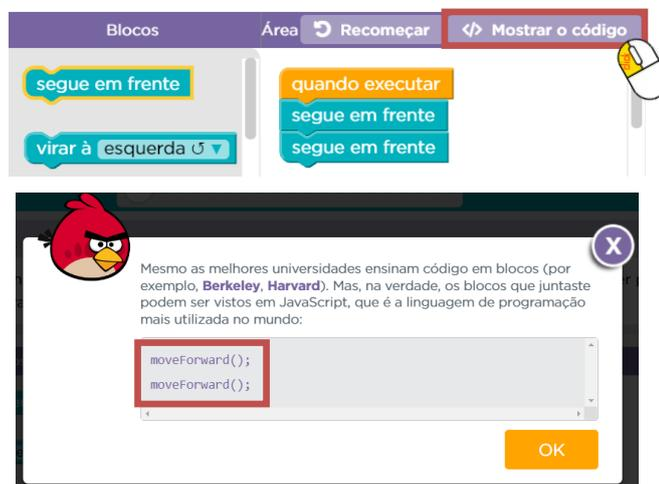
Repara que **cada bloco segue em frente** corresponde a uma **chamada da função `moveForward()`**; (`move_em_frente`)
