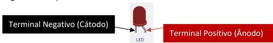
O **LED**, ao **contrário** de uma **lâmpada**, só funciona se for **corretamente ligado** pois tem **polaridade**. Ao ser **ligado** tens de **garantir** que **ligas** o **positivo** e o **negativo** **corretamente**.
